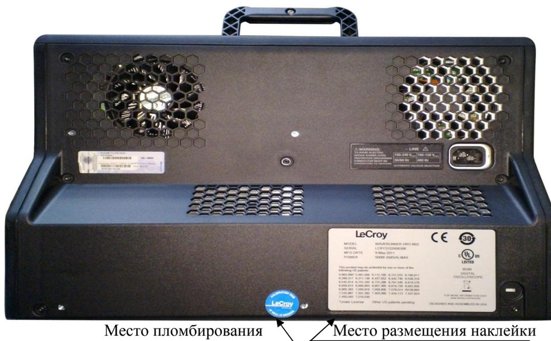
Рисунок 3 - Схемы для размещения наклейки и пломбировки от несанкционированного доступа
