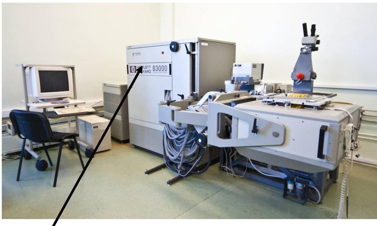
Рисунок 2 - Общий вид тестера HP83000 F330t с местом для нанесения оттисков клейм или размещения наклеек
