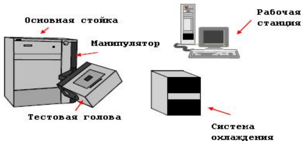
Рисунок 1 - Состав тестера НР83000 F330t
