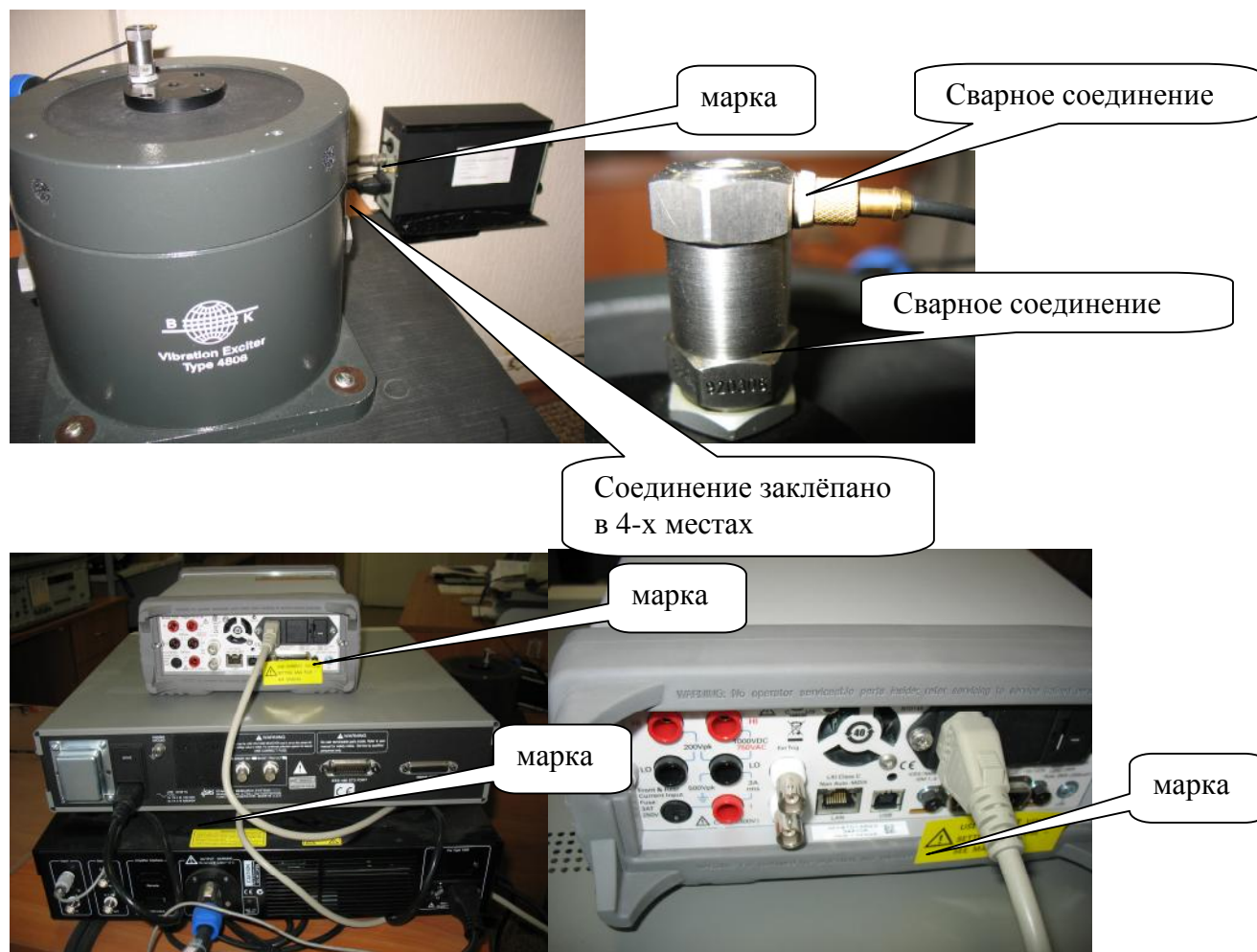
Рис. 2 Схема пломбировки виброустановки
