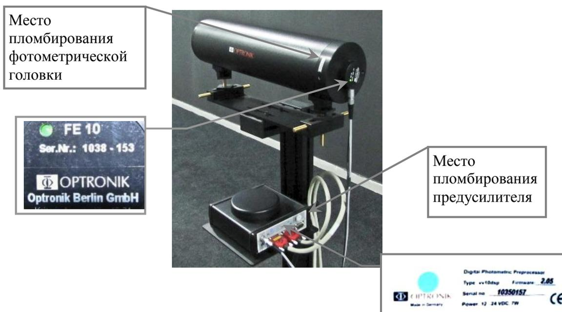
Рисунок 4 – Маркировка фотометрической головки FE10 и предусилителя vv10dsp
