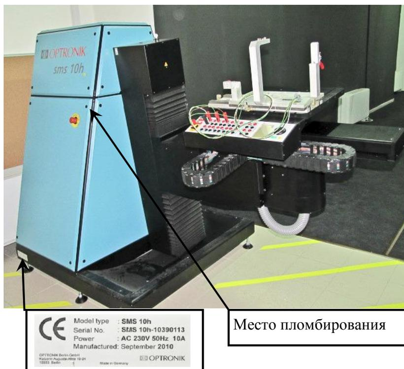
Рисунок 2 – Маркировка гониометра sms 10h
