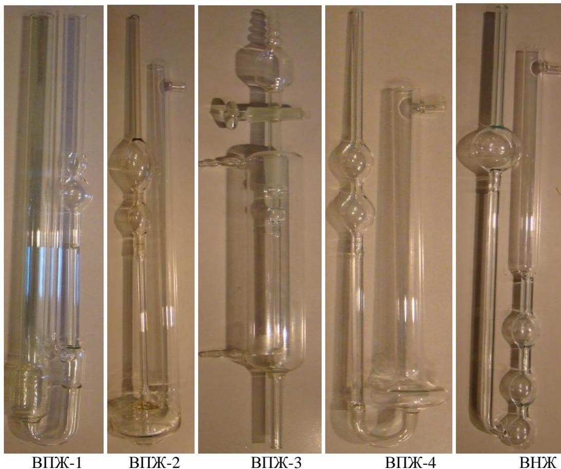
Рисунок 1 – Внешний вид вискозиметров
