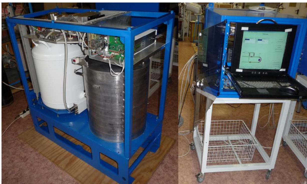
Рисунок 1 — Общий вид установки автоматизированной спектрометрической контроля инертных газов в выбросах АЭС СГГ-1002
