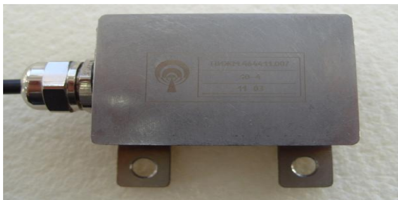
Рисунок 4 – Внешний вид модуля термокомпенсационного МТПАВ-30
