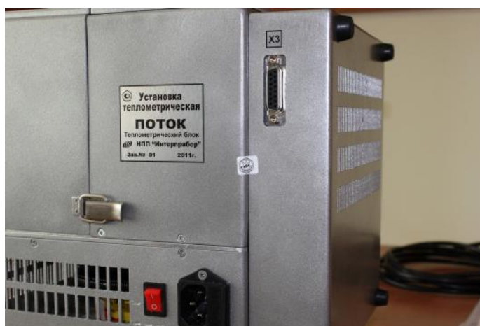
Рисунок 2 – Место пломбирования теплотрического блока
