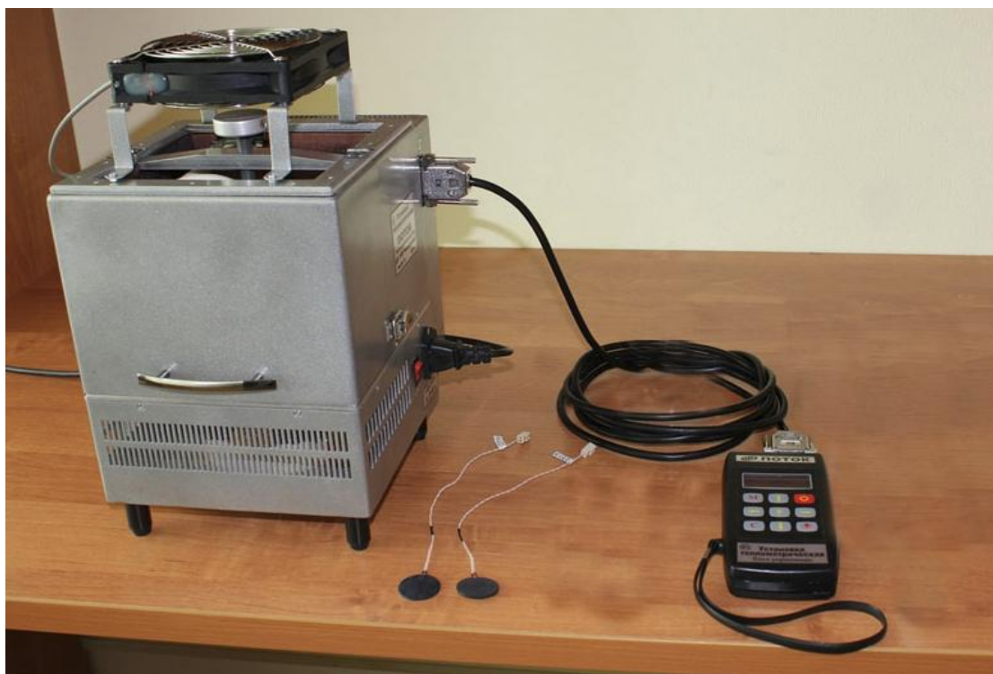
Рисунок 1 - Общий вид установки теплотрической «Поток»
