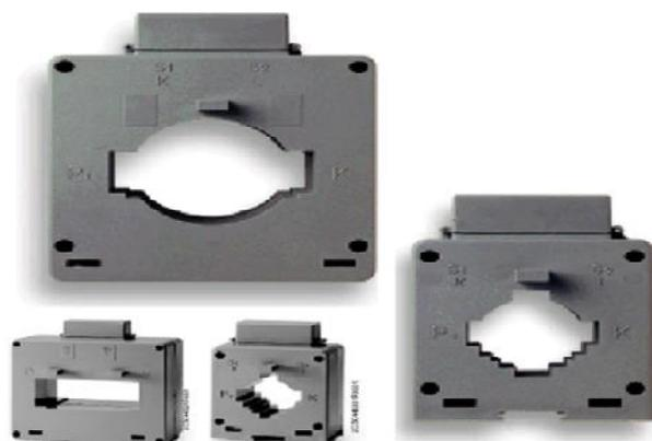
Трансформаторы тока СТ являются масштабными преобразователями и служат для расширения пределов измерения тока. По конструкции относятся к трансформаторам шинного типа. Типоисполнения различаются диапазоном первичного тока, размерами проходных отверстий и габаритными размерами. Трансформаторы СТ заключены в изолирующий корпус из термопластика. Вторичные обмотки равномерно намотаны на ленточные тороидальные магнитопроводы и обмотаны изолирующей лентой. Выводы вторичных обмоток подключены к
