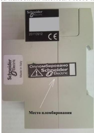
Рис. 2. Место пломбирования
