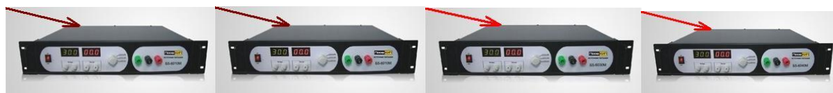
Рисунок 2 – Схема пломбировки от несанкционированного доступа.
