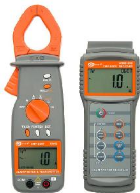
Рисунок 1 - Фотография общего вида клещей электроизмерительных СМР-600. Измеритель-передатчик СМР-600Т (слева), беспроводной приемник СМР-600R (справа).
