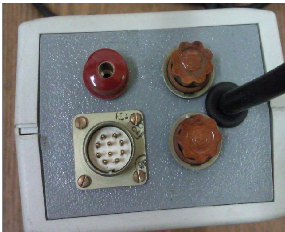
Рисунок 5 – Блок питания газоанализатора «ТЕСТ-902-2М», вид задней панели.
