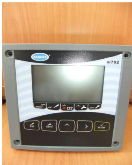
Рис. 1. Преобразователь измерительный потенциометрический модели si792x P
