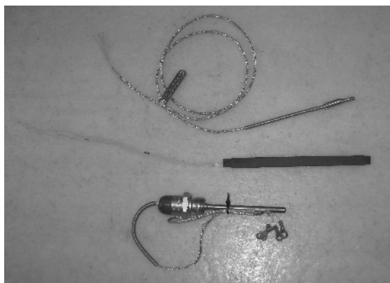
Рис.1 Термопреобразователи сопротивления ТСМ-0890.
