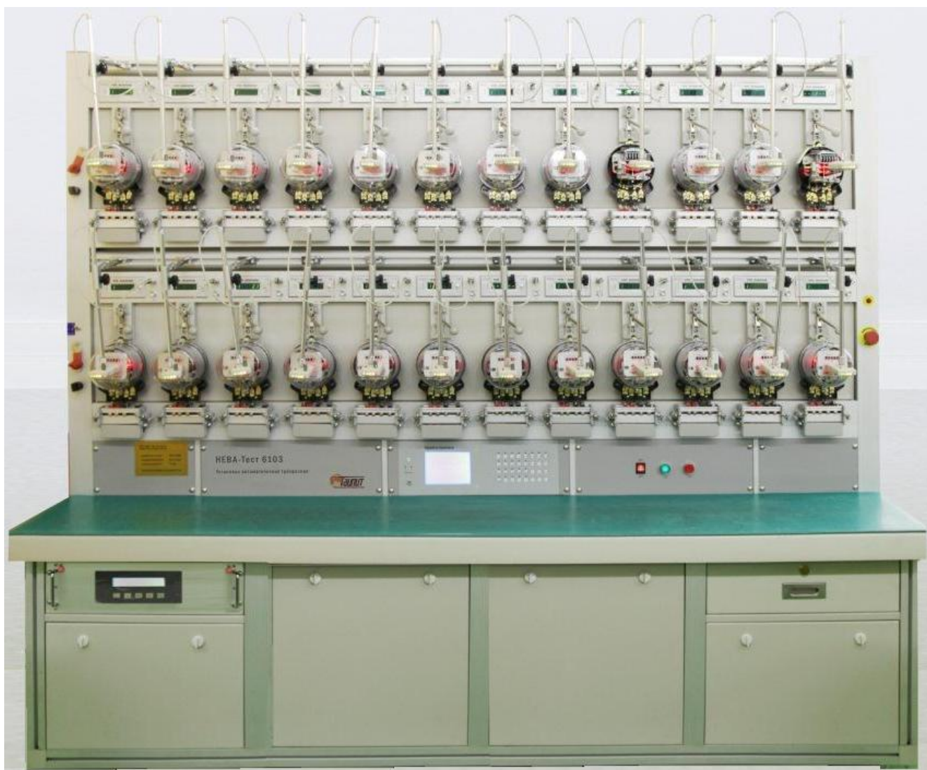
Рисунок 1. Внешний вид установки на 24 поверочных места
