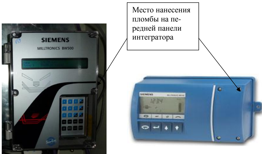
Рис.3-а Схема пломбирования BW500
