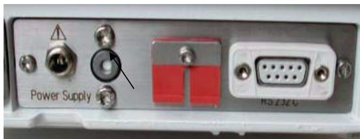
Рисунок 2 – Места пломбирования в зависимости от модификации весов
