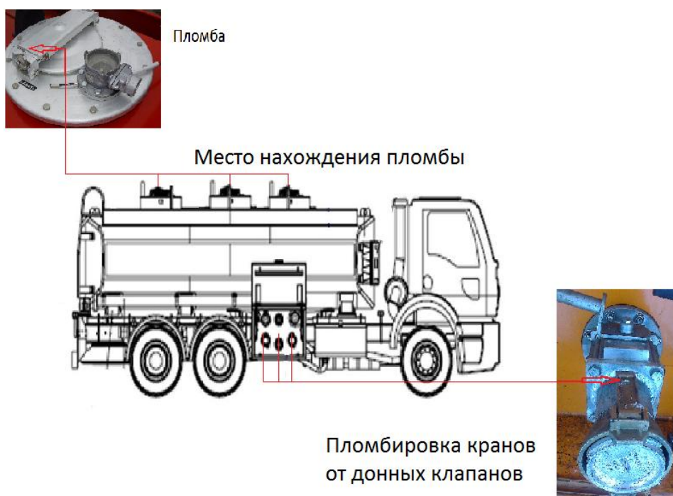
Рисунок 2 - Места пломбирования автоцистерны
