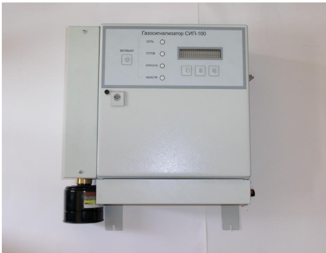
Рисунок 1 – Общий вид газосигнализатора автоматического СИП-100
