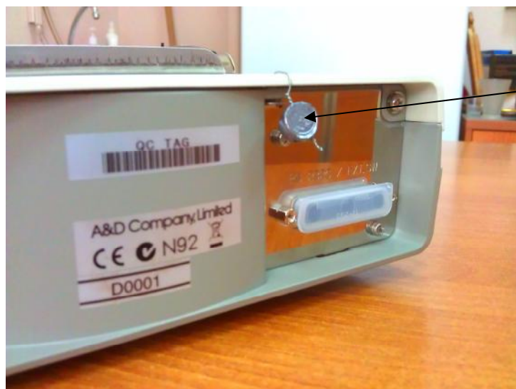
Рисунок 3 – Схема пломбировки компаратора
