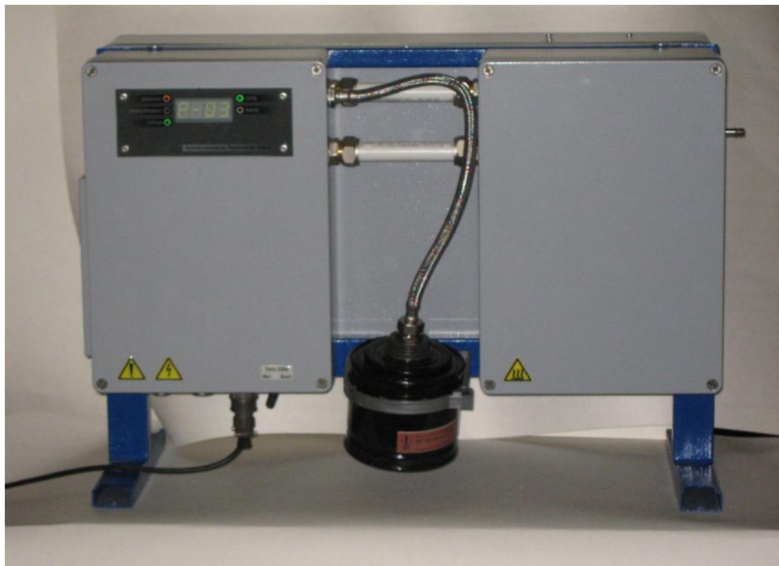
Рисунок 1 – Общий вид газосигнализатора
