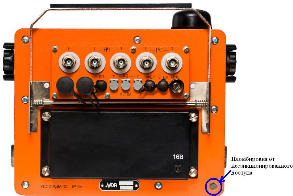
Рисунок 2 – Схема пломбировки электронного блока дефектоскопов от несанкционированного доступа
