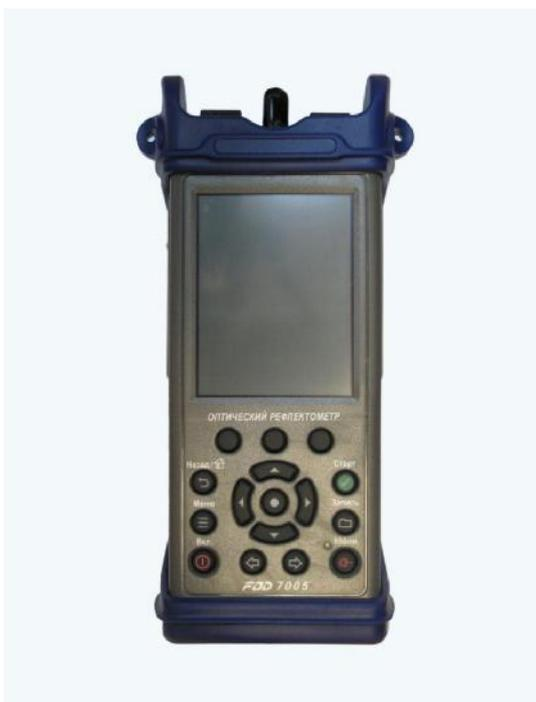
Рисунок 1- Рефлектометр оптический FOD-7000 - передняя панель
