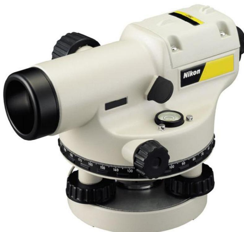
Общий вид нивелиров оптико-механических с компенсатором
