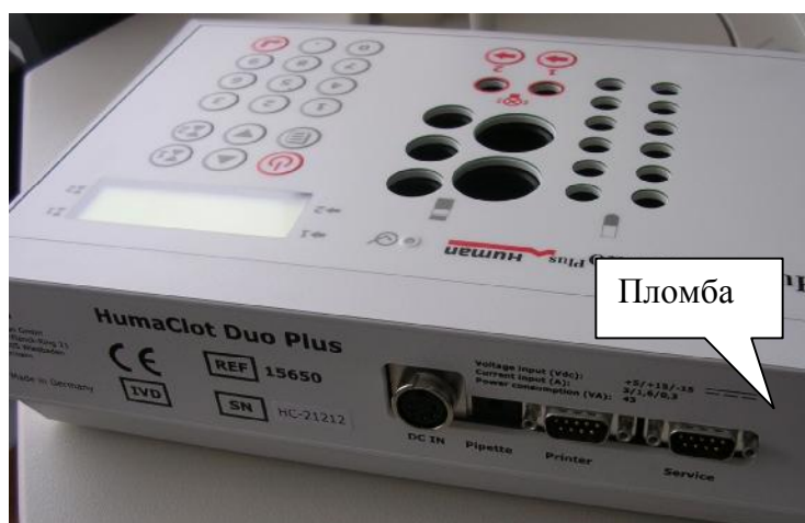
Рисунок 3 – Анализатор-коагулометр HumaClot Duo Plus. Расположение пломбы.
