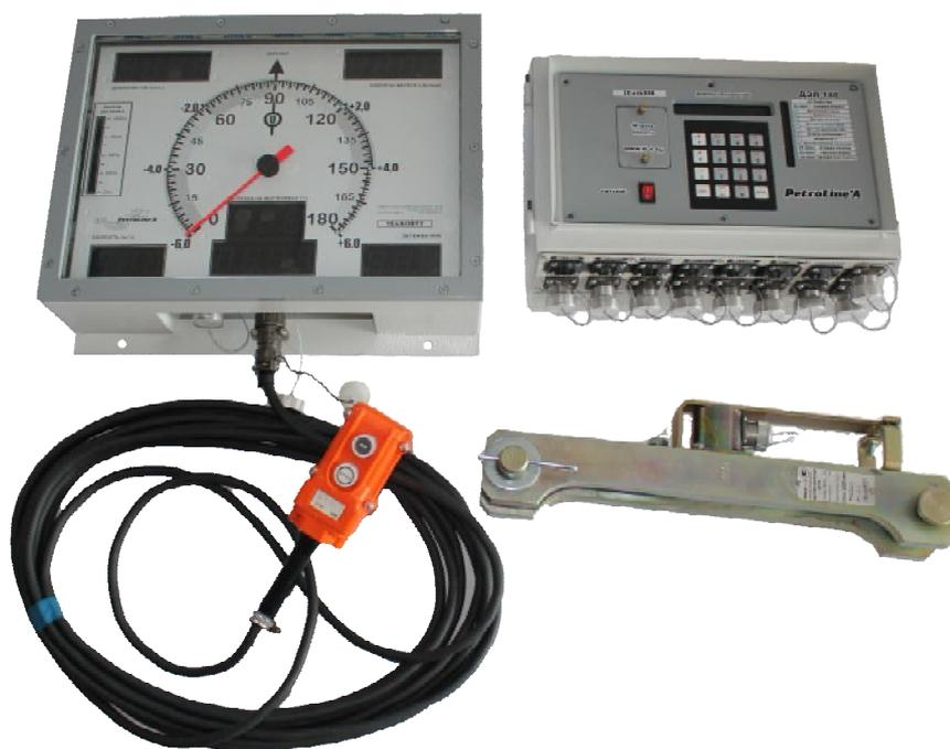
Фото 1 - Фотография общего вида динамометра электронного ДЭЛ-140
