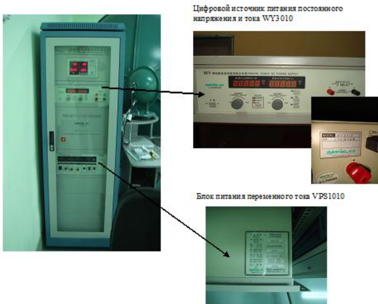
Рисунок 5. Цифровой источник питания постоянного напряжения и тока WY3010 и блок питания переменного тока VPS1010 и их маркировка.
