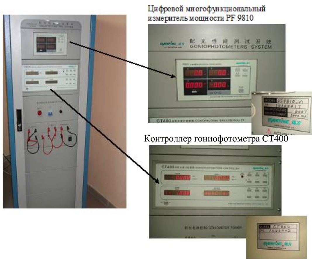
Рисунок 3 - Цифровой многофункциональный измеритель мощности PF 9810 и контроллер гониофотометра СТ400 и их маркировка.
