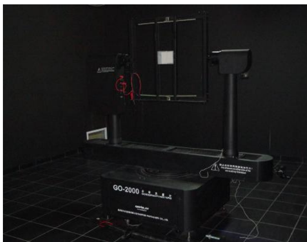
Рисунок 1 - Внешний вид гониометра GO2000B и его маркировка.
