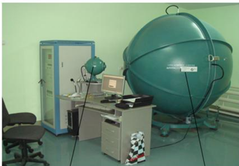
Рисунок 1 - Внешний вид гониометра GO2000B и его маркировка.
