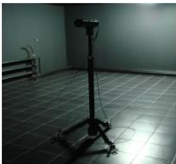
Рисунок 4 - Фотометрическая головка ID-1000 и ее маркировка.
