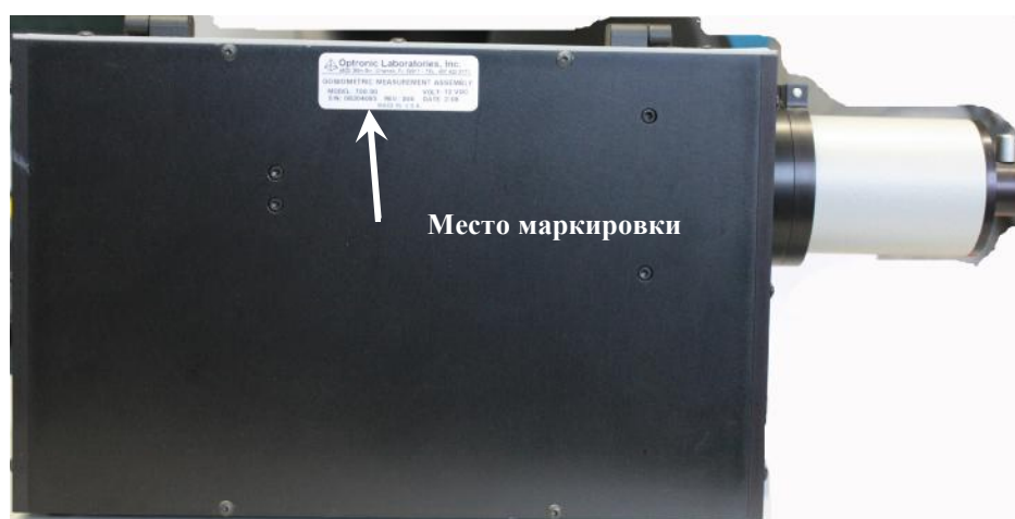
Рисунок 5 - Схема маркировки гониометра 700-30
