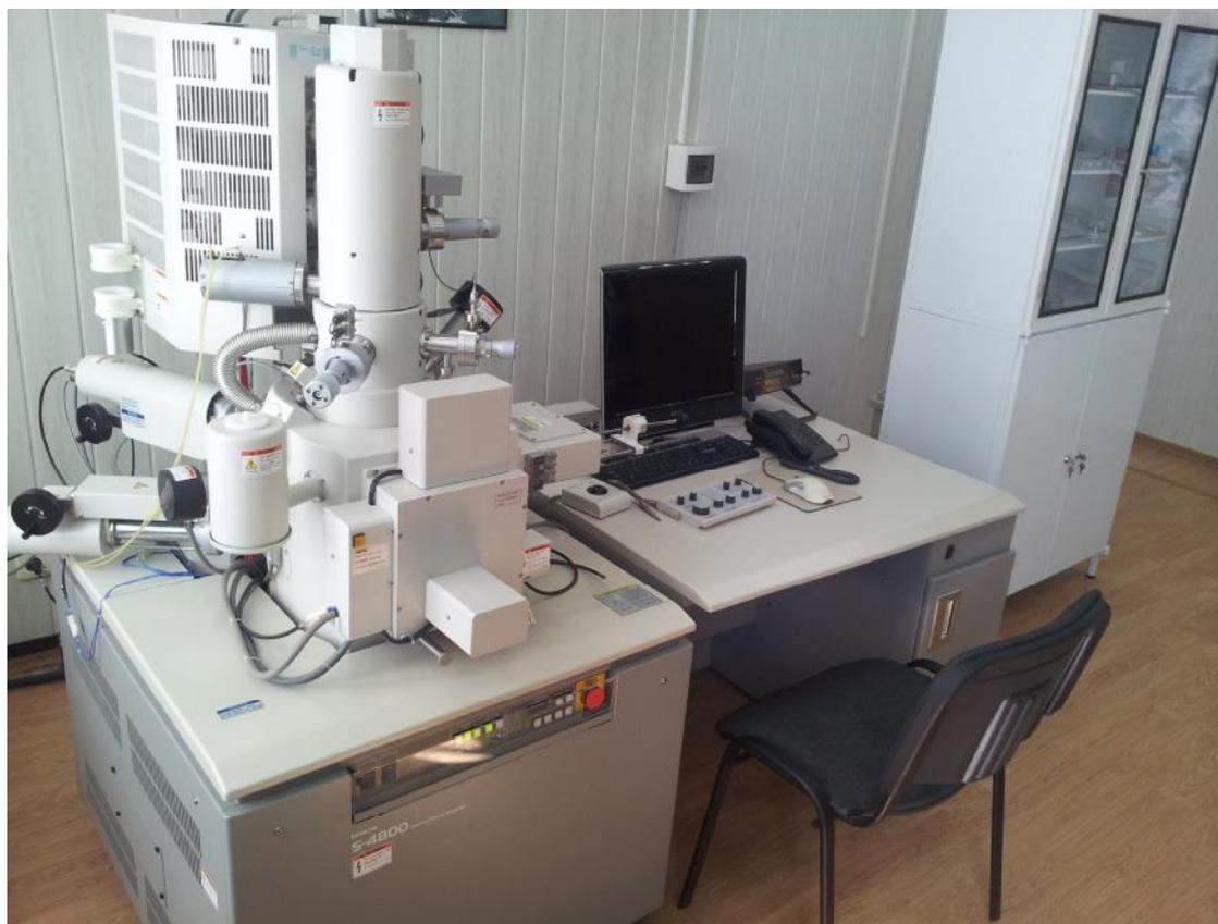
Рис.1. Общий вид микроскопа электронного растрового S-4800
