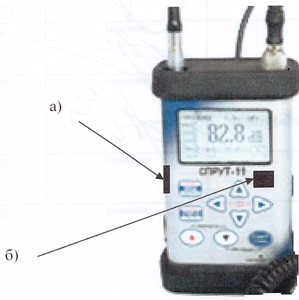
Рисунок 2 - Схема пломбировки от несанкционированного доступа (а) и обозначение мест для размещения наклеек (б) на измерительном модуле
