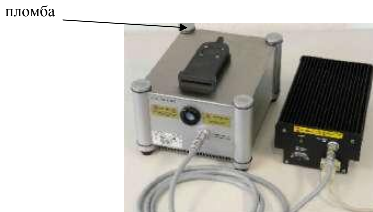
Рис. 1. Рефрактометр автоматический Abbemat ® , модель WR
