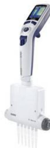
Рисунок 3 – Внешний вид многоканального электронного дозатора с регулируемым шагом
