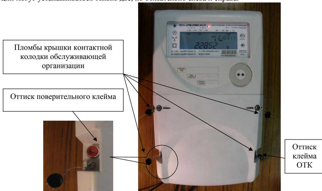
Рисунок 1 – Внешний вид счетчика с закрытой крышкой контактной колодки и схема пломбирования
