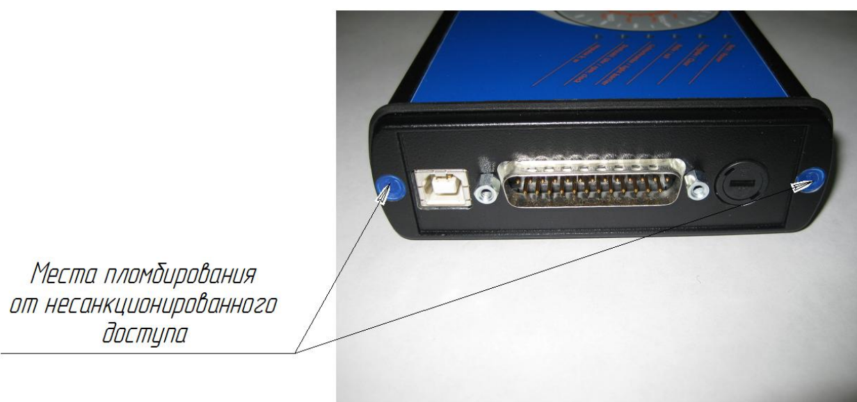
Рис.2 Контроллер системы поверочной TCS, схема пломбировки от несанкционированного доступа
