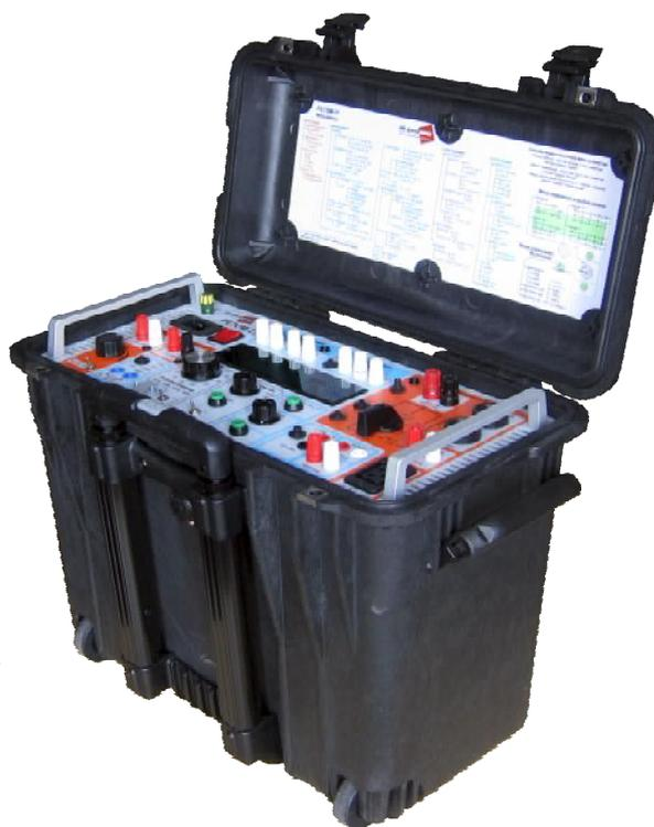
Рисунок 1 - Общий вид устройства измерительного параметров релейной защиты
