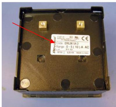
Рисунок 2 - Схема пломбировки от несанкционированного доступа амперметров, вольтметров ERI, ERC, ERIL, ERCL
