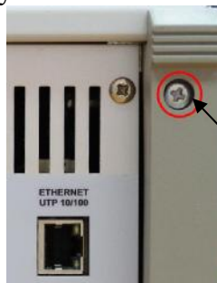
Рисунок 2 – Место на задней панели для пломбирования
