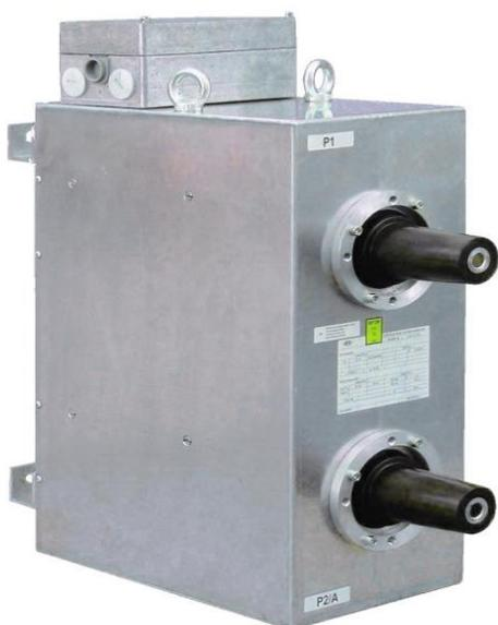
трансформатор напряжения электромагнитного типа. Обмотки изолированы специальным компаундом и заключены в металлический корпус. Подключение кабелей к выводам первичной обмотки осуществляется с помощью специальных разъемов. К одному из разъемов также подсоединён высоковольтный ввод трансформатора напряжения.
