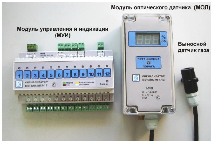
Рисунок 1 - Общий вид сигнализатора метана МГА-12
