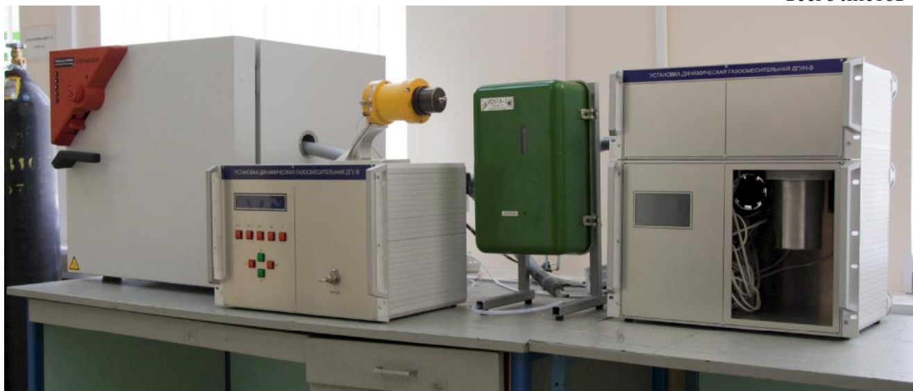
Рис 1. Внешний вид рабочего эталона 1-го разряда – комплекса динамического газосмесительного ДГК-В (слева направо): термошкаф Binder, установка ДГУ-В с оптическим анализатором, искровой сигнализатор, установка ДГУН-В.
