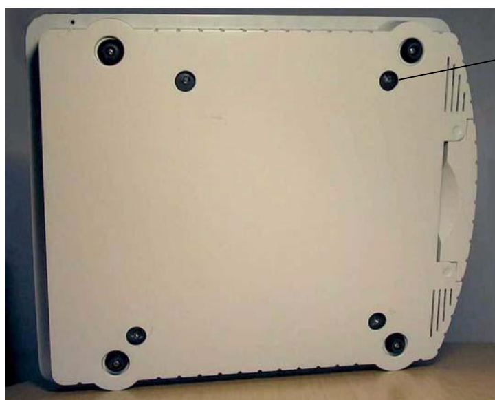
Рисунок 3 - Место нанесения знака утверждения типа, маркировки и пломбирования Спектрофотометра Soleris 32.
