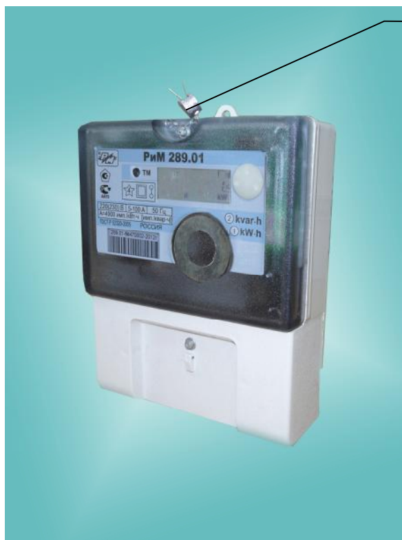
Рисунок 1 – Фотография общего вида и место установки пломбы поверителя счетчиков РИМ 289.01
