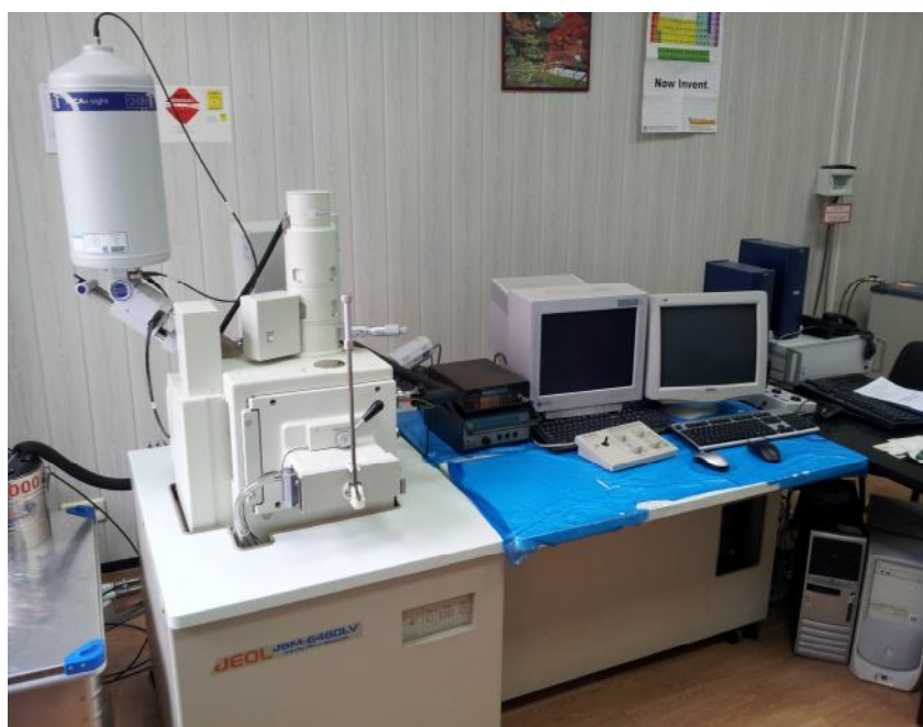
Рис.1. Общий вид микроскопа электронного растрового JSM-6460LV
