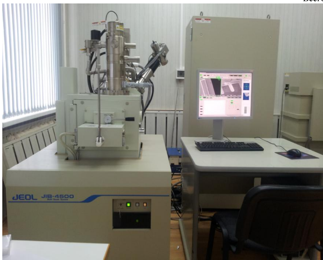
Рис.1. Общий вид микроскопа электронно-ионного растрового JIB-4500
