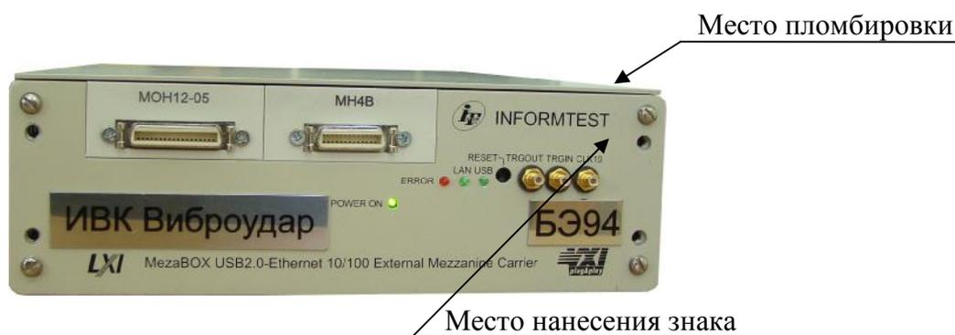
Рисунок 2 – Внешний вид БЭ94 с местом нанесения знака утверждения типа и местом пломбировки
