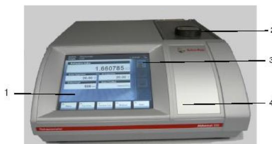
1 - цветной ЖК сенсорный дисплей; 2 – съемная крышка отсека для измеряемого образца;
