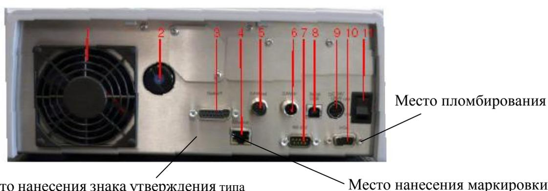
1 – вентилятор; 2 – осушительный картридж; 3 – интерфейс для дополнительных устройств;
