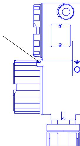
Стрелкой указано место пломбировки от несанкционированного доступа и обозначение места для нанесения оттисков клейм.
