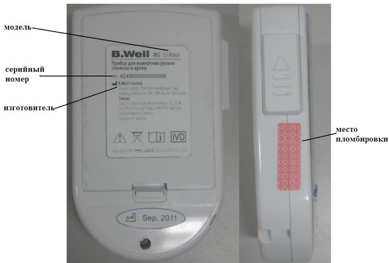
Рисунок 3 – Схема маркировки и пломбировки
