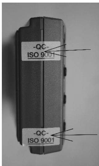
Рисунок 2 - Место пломбирования от несанкционированного доступа
